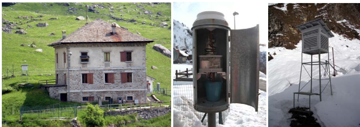
Figure 2 : A gauche : station de Alpe Cavalli située près de la maison des opérateurs du barrage ; en centre : le pluviographe à bascule, situé sur le côté Sud ; à droite : le poste climatologique, situé sur le côté Nord.
