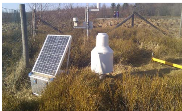
Figure 2 : Pluviographe OTT à pesée à la Station automatique du Mont Rigi (MR)
