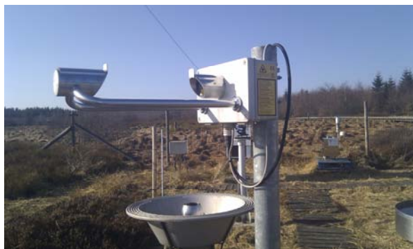
Figure 1 : Disdromètre à laser THIES à la Station automatique du Mont Rigi (MR)
