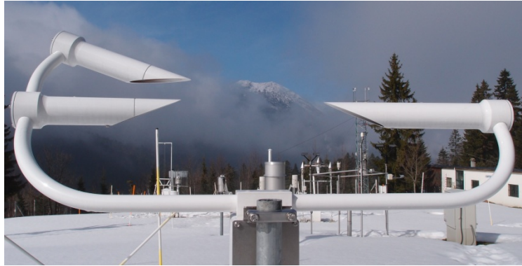
Figure 1 : Le PWS100 installé au Col de Porte (photo : mars 2011). L'émetteur est à droite sur cette photo.
