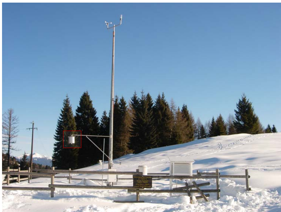
Figure 4 : Station météorologique manuelle-automatique PAT de Folgaria-Passo Sommo avec bien remarqué le nivomètre à ultrason (photo Fazzini, janvier 2009)
