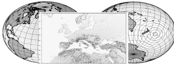
Figure 1. Modèle numérique climatique global : exemple d'ARPEGE-Climat (Résolution de 50km sur l'Europe occidentale et de 450 km sur le Pacifique Sud) (Source : Météo-France).
