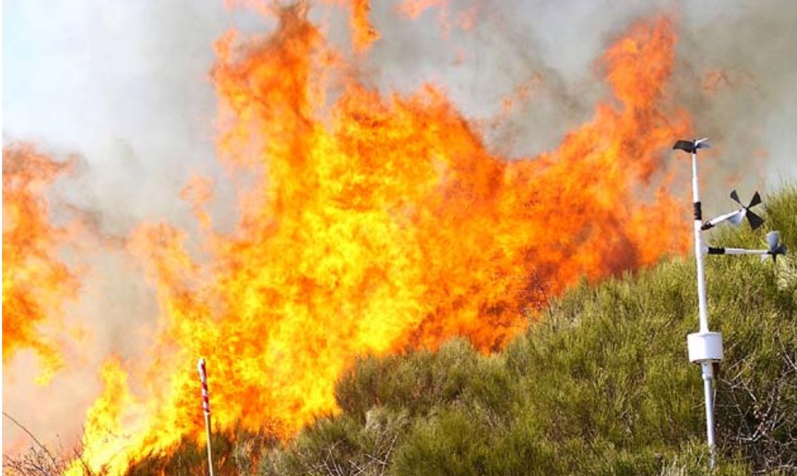
Figure 2. Expérience en cours à Escragnoles (1150m), le 13 mars 2006 dans une garrigue à genêt cendré d'1m50 de hauteur. Les flammes qui arrivent dépassent 10 m de hauteur. A droite l'anémomètre B., et à gauche l'un des repères décimétriques.
