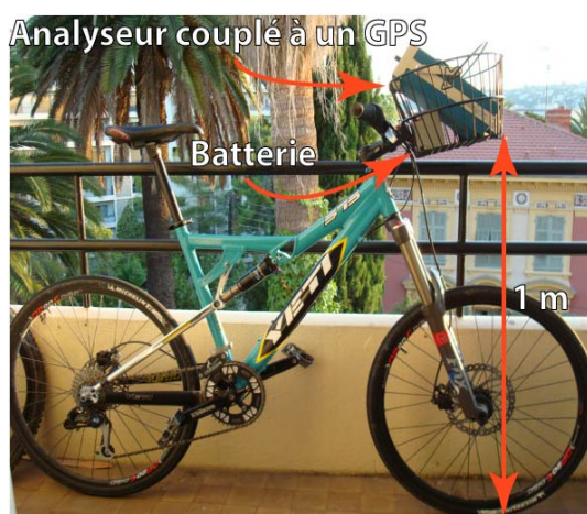
Figure 1 Mode de transport et dispositif de mesure
