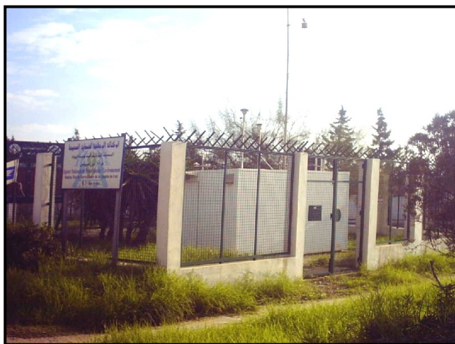
Fig.1 : la station de mesure de la qualité de l'air de Ben Arous
