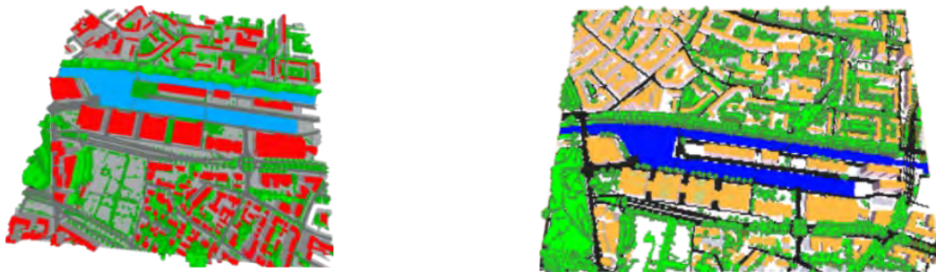
figure 2. La zone d'étude strasbourgeoise Malraux modélisée par LASER/F (a) et ENVI-Met (b). Les bâtiments sont en rouge (pour LASER/F) et beige (pour ENVI-Met), les routes en gris foncé (pour LASER/F) et noir (pour ENVI-Met), la végétation en vert et
