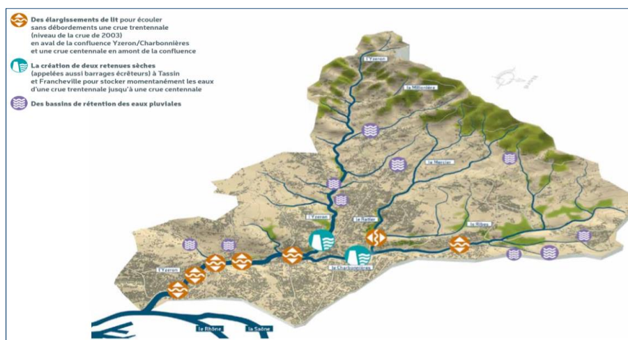
Figure 8. Les aménagements à l'échelle du bassin versant, Source : SAGYRC
