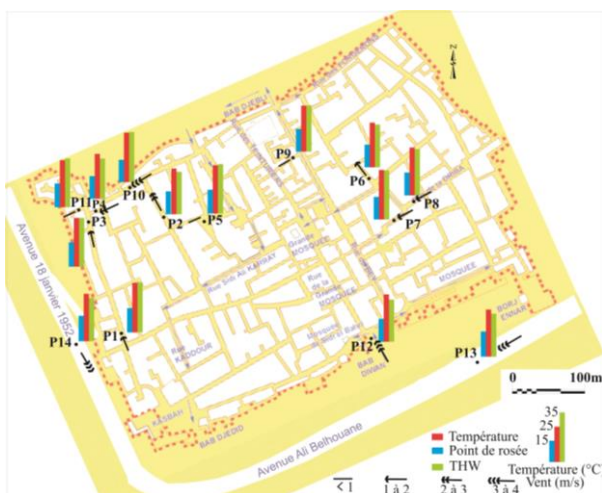
Figure 4. Campagne de mesure de température, d'humidité et de la vitesse du vent le 21 août 2017 dans la Médina de Sfax
