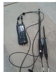
Figure.2. L'appareil de mesures (Le Testo 480). (Source: Auteur 2015) ►
