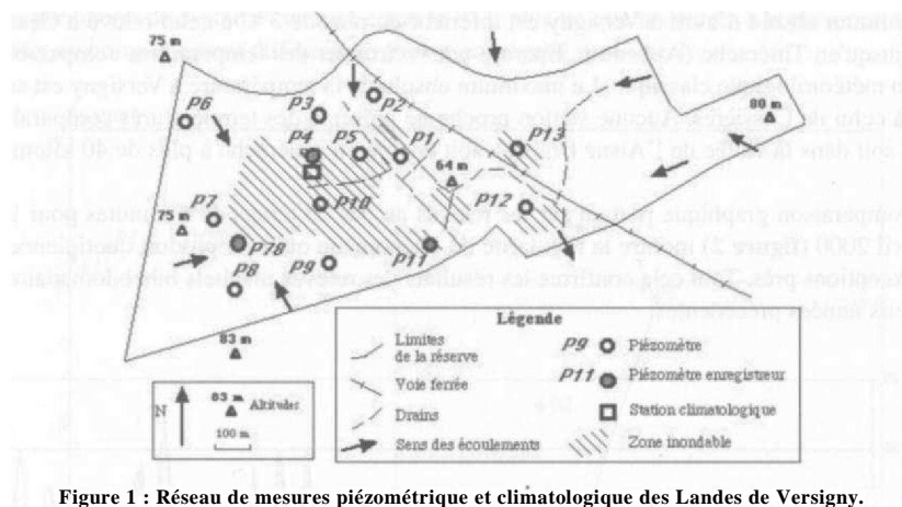
Figure 1 : Réseau de mesures piézométrique et climatologique des Landes de Versigny.
