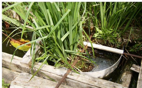
**Figure 3.** Le bac évapotranspiromètre au bord du lac Căldărușani (Photo : Stan, 2015)
