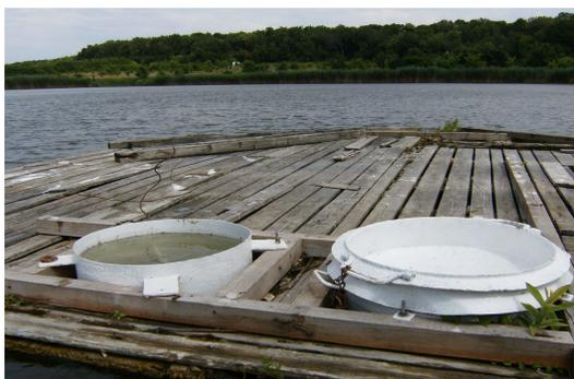
**Figure 2.** Le bac flottant de type GGI-3000 au bord du lac Căldărușani (Photo : Stan, 2015)
